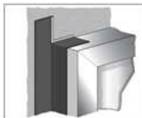
Figure 8: Pose bande verticale avec rabat côté à la Festix OT15 sur la menuiserie
