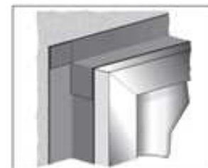
Figure 9: Pose bande horizontale avec rabat côté à la Festix OT15 sur la menuiserie
